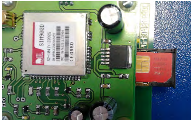
Фото 16.1. Установка лотка на место
