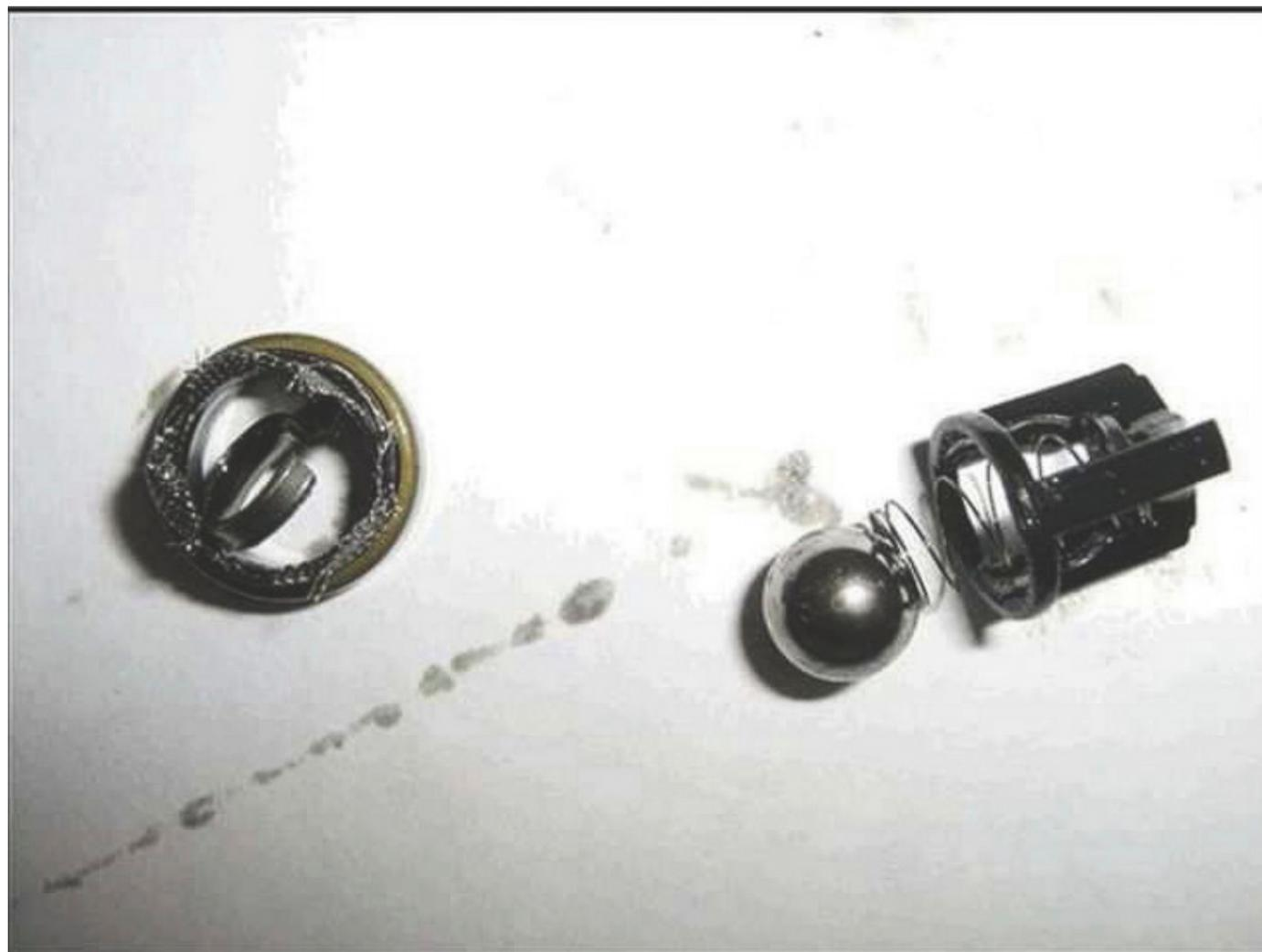
**Запорный клапан в регуляторе положения распредвала может сломаться. По словам представителя VW, у мотора Golf GTI он имеет усиленную конструкцию. TPI 2024866 говорит о другом**
