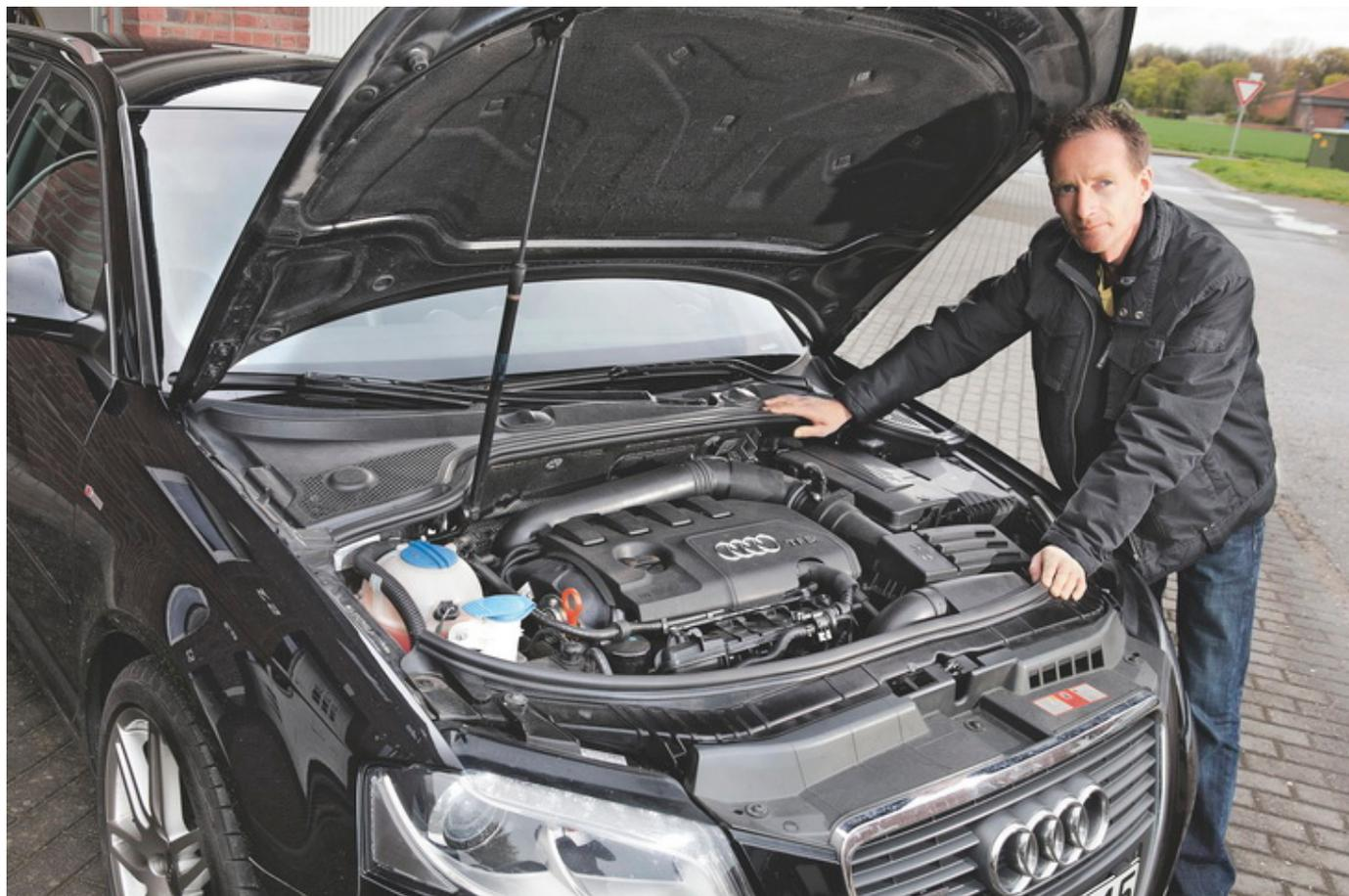
При пробеге в 93.000 км в моторе Audi A3 Франка Дамена был заменен фазовращатель (компания 15D6). Но спустя 15.000 км цепь все равно перескочила на пару звеньев. Мотор был поврежден, стоимость ремонта составила €7000. Дилер Audi компенсировал 70% этой стоимости.
