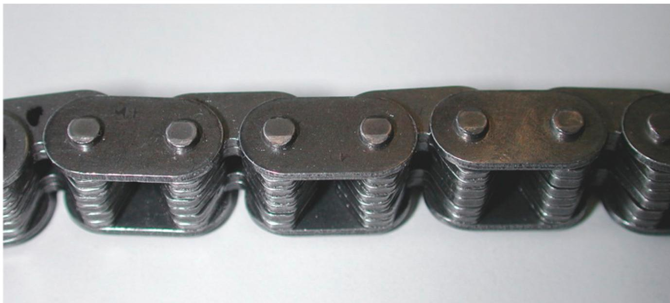
**Пластина цепи ГРМ мотора TSI**
