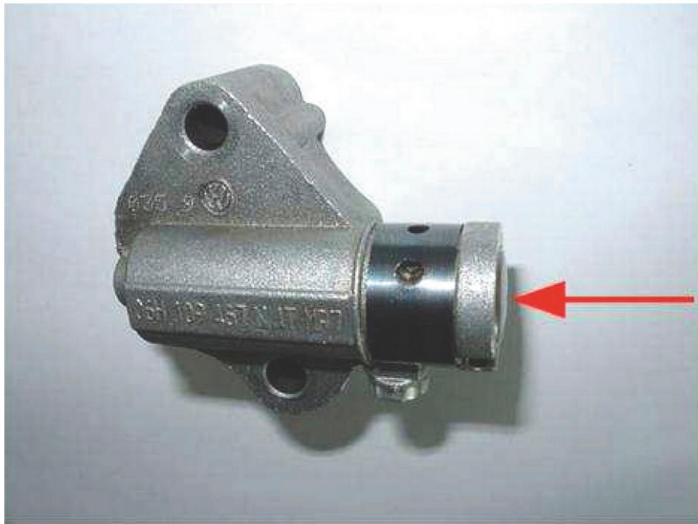
При работе двигателя натяжитель приводится гидравликой. если по какимто причинам давление масла падает, натяжитель отстает, цепь ослабевает и может перескочить (TPI 2025206)
