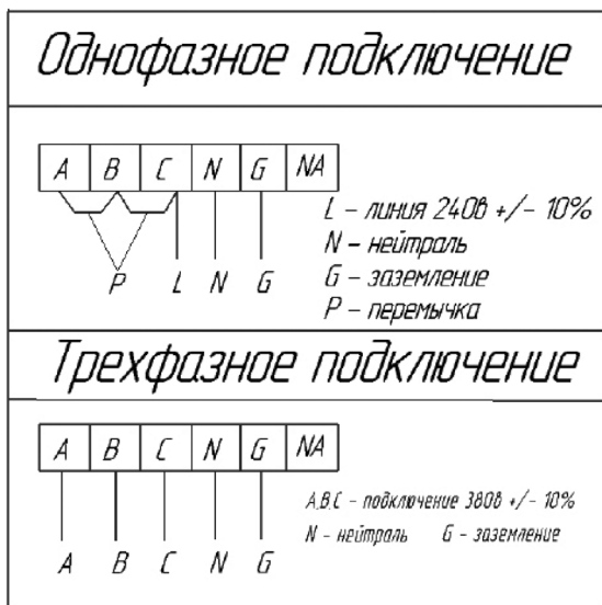
Рис. 4. Схемы подключения электрического котла к электросети.
